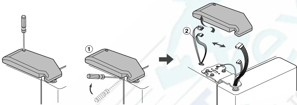
2) Отверните винты крепления верхней петли (③) и заземляющий винт (④) против часовой стрелки и снимите верхнюю петлю (⑤) в направлении, указанном стрелкой (⑥). Во время разборки будьте осторожны, чтобы дверца не упала на вас.
