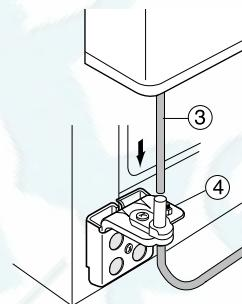
3) Вставьте стержень верхней петли (⑤) в отверстие (⑥), после того, как совместите отверстие в верхней петле (⑦) с отверстием в корпусе холодильника (⑧). Заверните болты (⑨) и винт (⑩) по часовой стрелке.
