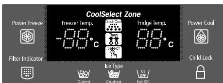
Индикатор **Freezer Temp.** (Температура в морозильной камере ) показывает текущую температуру в морозильной камере .
