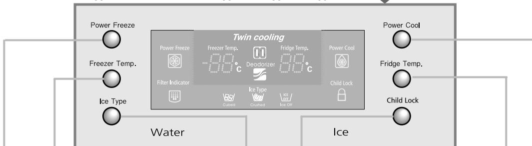
**КНОПКА FREEZER TEMP.** (Температура в морозильной камере)
